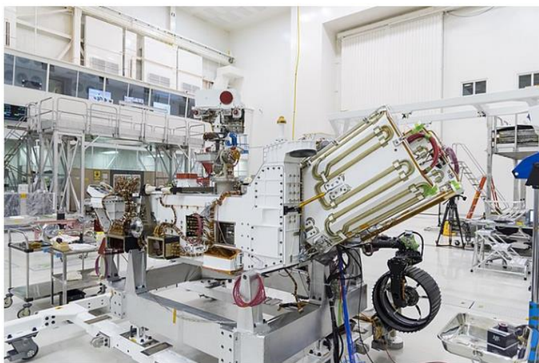
Le radiateur sur lequel doit être fixé le MMRTG est visible sur cette amorce de l'arrière du rover.
