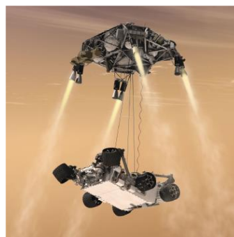
Séparation du rover maintenu par 3 câbles et connecté par un cordon ombidical
