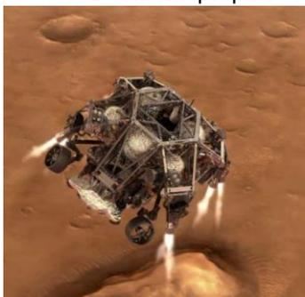
Séparation du rover maintenu par 3 câbles et connecté par un cordon ombidical
