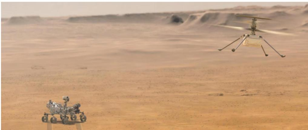
**Deux expériences doivent être tester** sur le terrain : MOXIE produit de l'oxygène à partir de l'atmosphère martienne (ISRU) et **MHS (Ingenuity), un petit hélicoptère de moins de deux kilogrammes**, va tester les capacités d'un engin aérien dans l'atmosphère très ténue de Mars.
