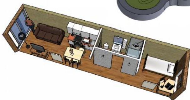
Aménagement d'un conteneur en logement étudiant
