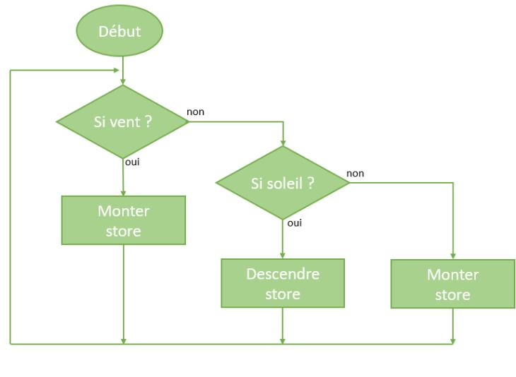
Un Algorithme sous la forme d'un **logigramme** est toujours composé des éléments suivants :
