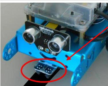
Le robot mbot utilise **2 capteurs à infrarouge** pour détecter du blanc ou du noir.
