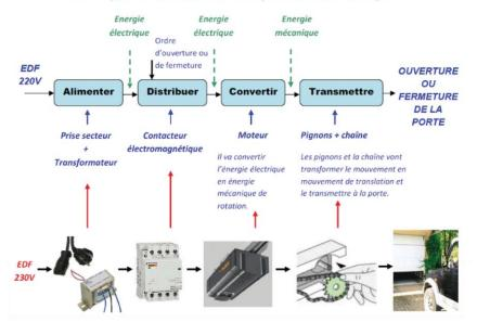
Dans le schéma de fonctionnement global d'un système, la chaîne d'énergie est associée directement à la chaîne d'information car elle reçoit des ordres pour réaliser l'action attendue.
