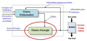
La structure et le fonctionnement d'un objet technique peuvent être expliqués en étudiant sa chaîne d'énergie. Cette chaîne fournit au système l'énergie nécessaire à son fonctionnement. On retrouve généralement les fonctions : Alimenter et/ou Stocker, Distribuer, Convertir, Transmettre.
