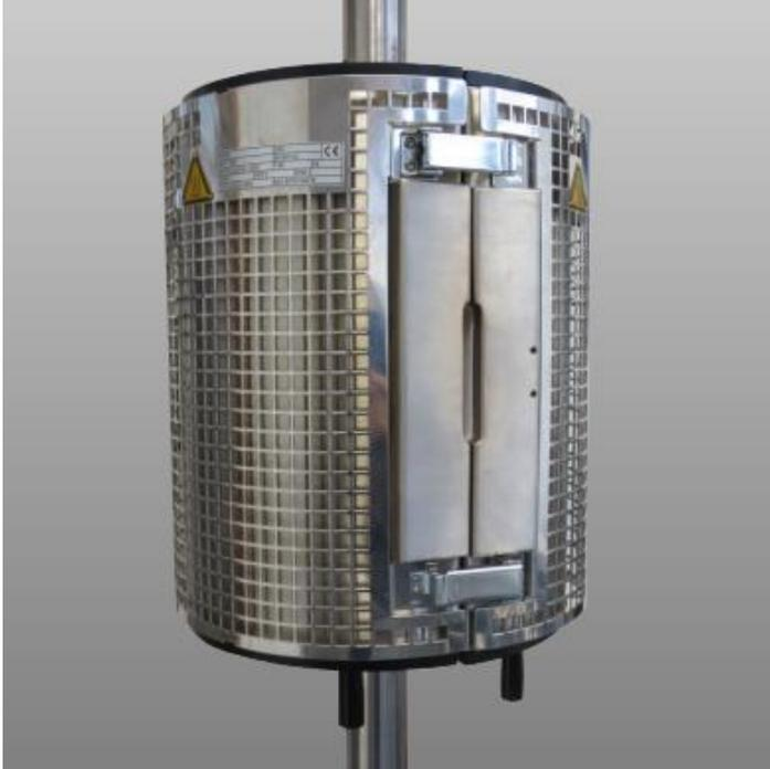
Le **four à haute température** est utilisé pour déterminer les propriétés techniques de **résistance aux hautes températures** des matériaux.
