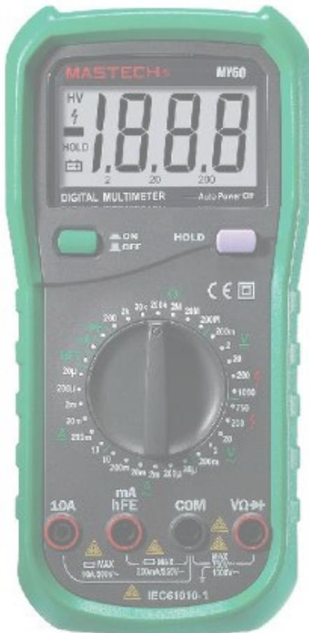
Le **multimètre** va nous permettre de déterminer si le matériau **laisse passer le courant (matériau conducteur)** et s'il **ne laisse pas passer le courant (matériau isolant)**.
