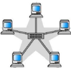
Le réseau en étoile est une architecture où **tous les éléments du réseau sont connectés à un commutateur** (répartiteur ou switch). C'est l'architecture la plus courante mais d'autre topologie existe.
