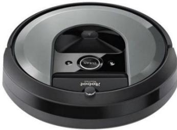
Les poussières aspirées sont déposées dans un compartiment. Le compartiment à poussière a une taille limitée et un capteur est prévu pour prévenir l'utilisateur lorsque le **niveau maximum** de poussière est atteint (**l'aspirateur s'arrête** et déclenche un **signal sonore**).
