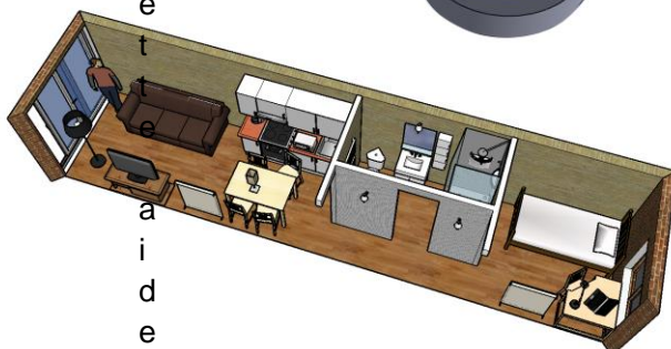
Aménagement d'un conteneur en logement étudiant
